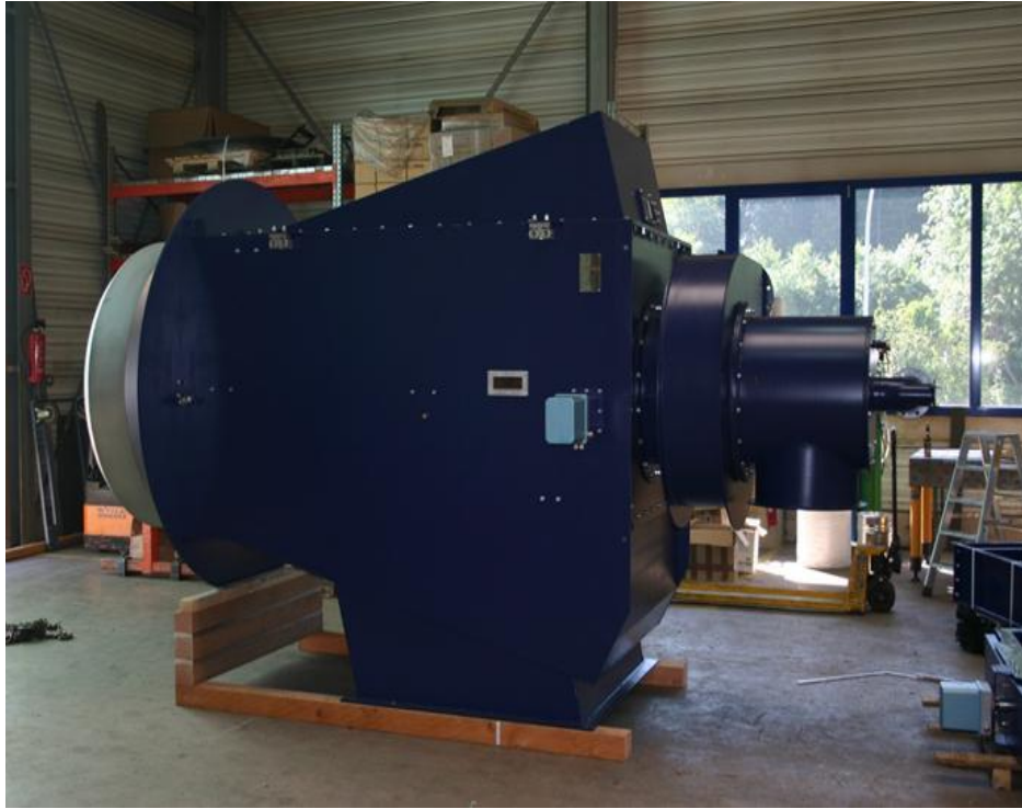
75 MW Gas- / Dust Burner = 16.000 kg Dust per hour
